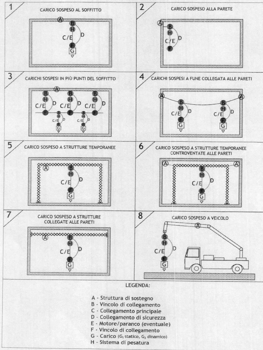
Fig. 1 - Schemi ricorrenti di tipologie di carichi sospesi
